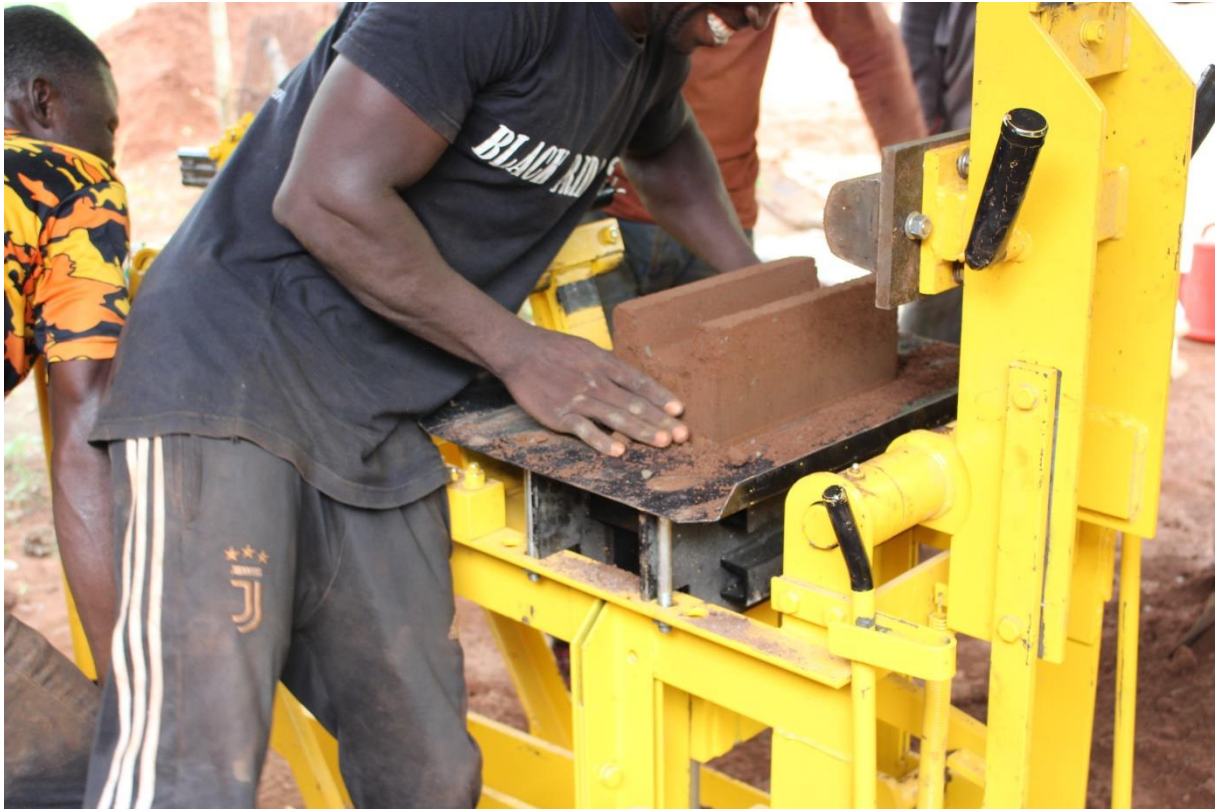
Die neue Ziegelpresse in Aktion, mit lokaler Erde aus der eigenen Lehmgrube und etwas Zement.
