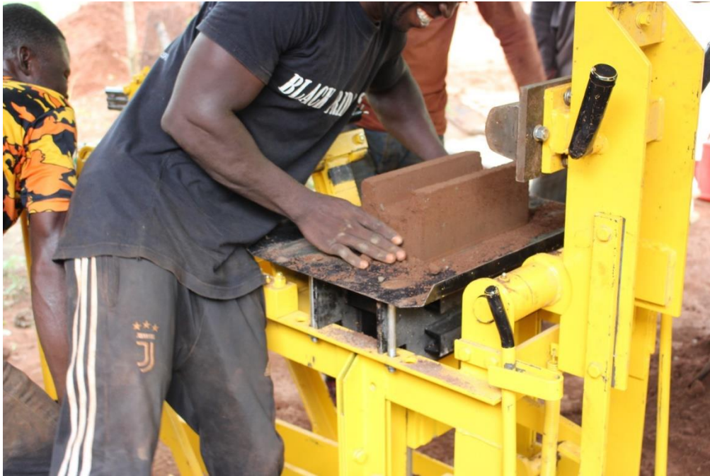
Abbildung 11 Die neue Ziegelpresse der Modellfarm in Aktion, mit lokaler Erde aus der eigenen Lehmgrube und etwas Zement, können viele verschiedene Formen gepresst werden.
